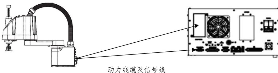
图 2.1 GBT-S3A 机器人与控制柜连接示意图
