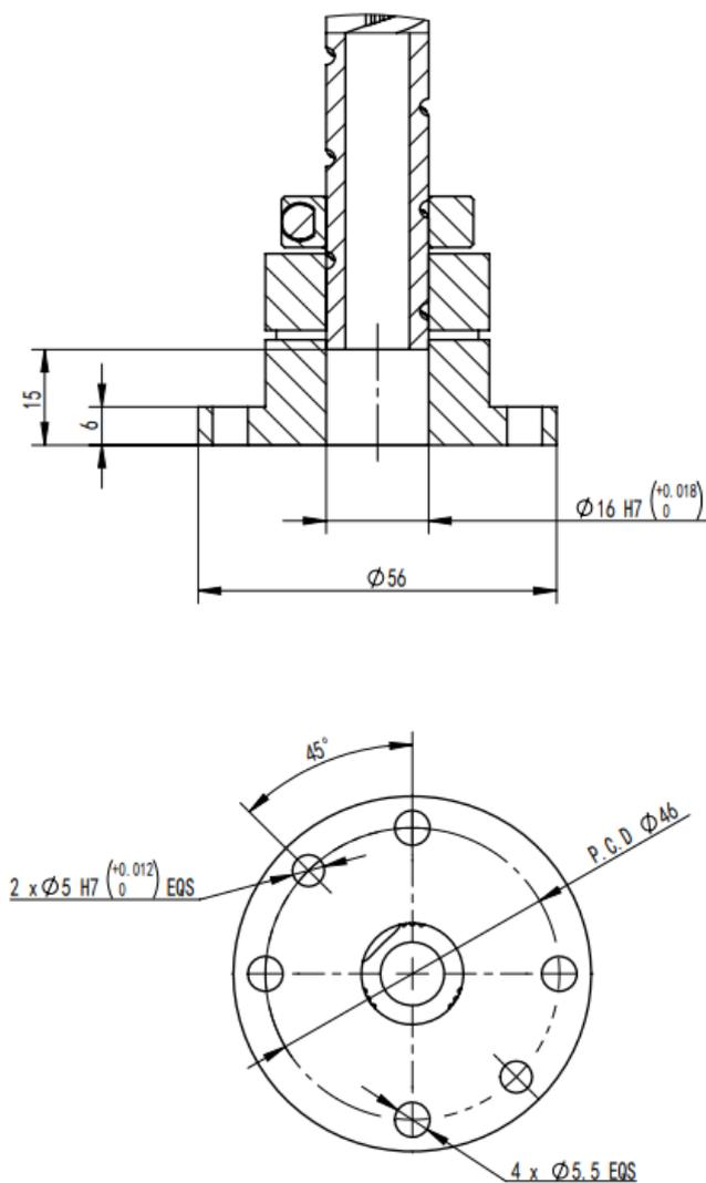
图 4.2 GBT-S3A 机器人末端法兰接口尺寸
