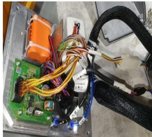
图 6.3 内部电池固定示意图
