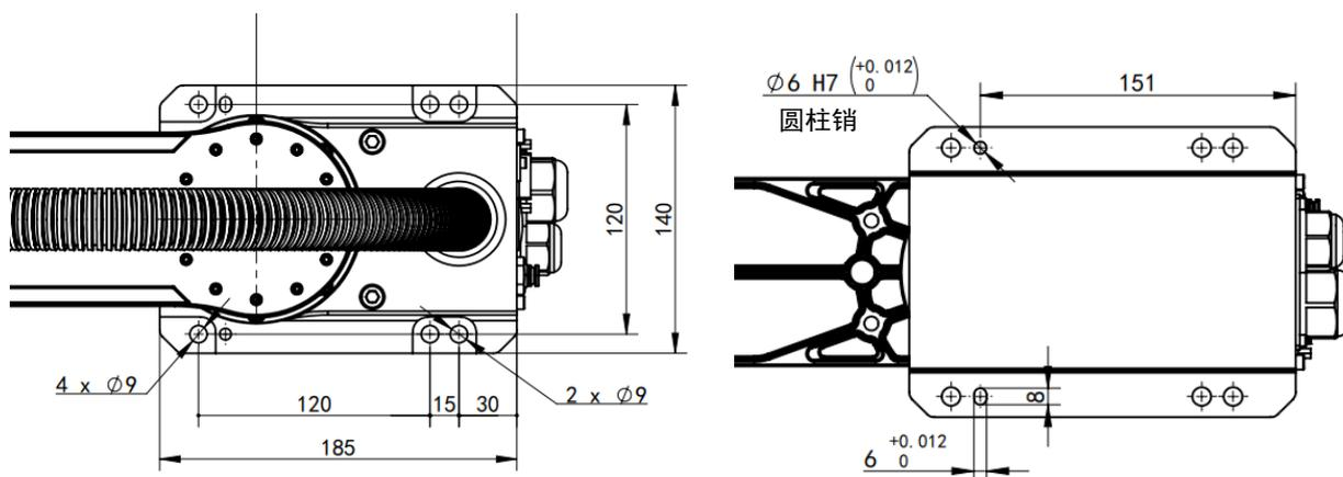
图 1.2 GBT-S3A 机器人安装尺寸
