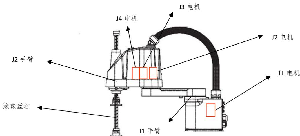
图 3.1 GBT-S3A 机器人电机位置示意图
