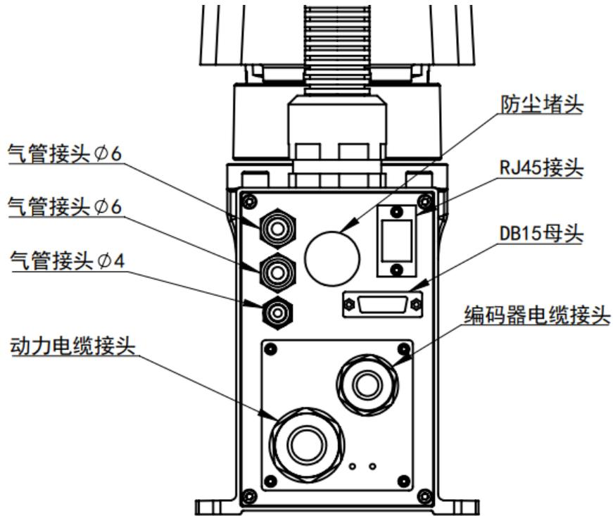
图 5.1 底座气管和电气接口位置
