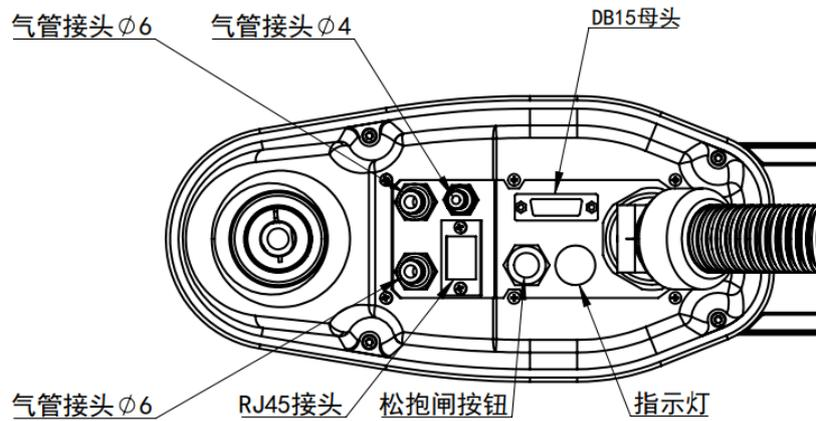
图 5.2 手臂气管和电气接口位置
