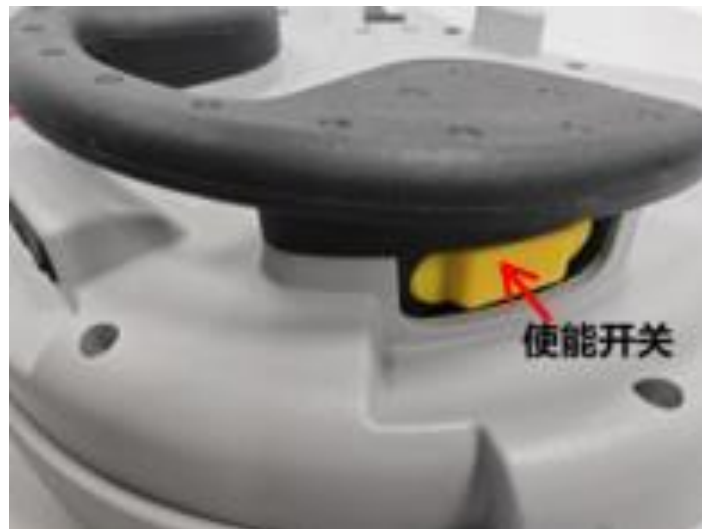
图 2.4 示教器背面示意图
