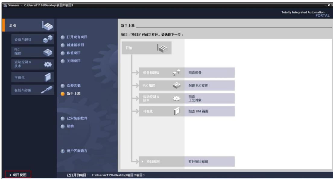
3.进入项目视图后，1: 添加新设备→ 2: 控制器 → 3: CPU 1215C DCDCRLY.....（根据现场 PLC 型号选择相应的型号与版本，PLC 型号可在正面右侧或 PLC 侧面查看）→ 4: 选择对应的版本号 → 5: 点击确定；
