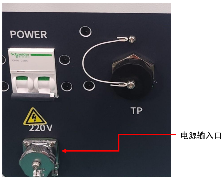
图 4.8 电源输入接口
