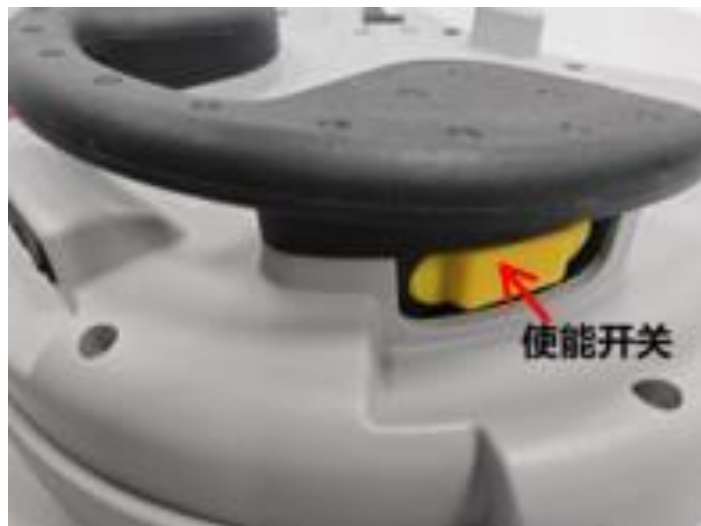
图 2.4 示教器背面示意图
